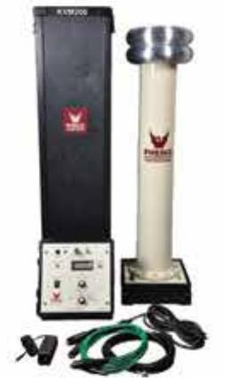
AC/DC Kilovoltmeter 200 kV
